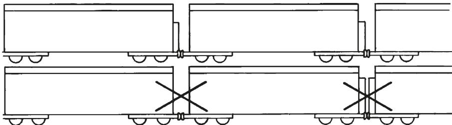
Die serienmäßig montierte Drahtbügelkupplung ist mit sämtlichen im Handel erhältlichen Kupplungen koppelbar.
